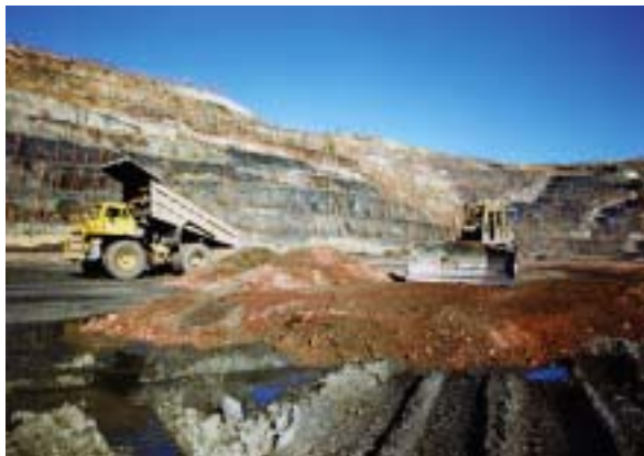
Verfüllung des Tagebaus Lichtenberg mit Haldenmaterial
